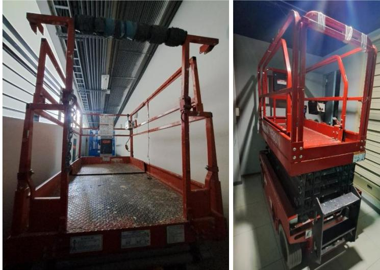
圖 8 高空工作車護欄失效
